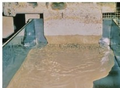
Produzione AIRBETON®: versamento della miscela di materie prime nella cassaforma.
