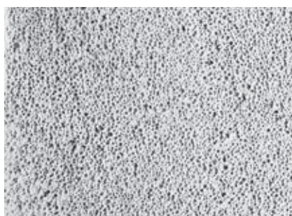
Struttura porosa a cellule chiuse di AIRBETON®.
