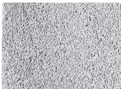
Le micro celle chiuse di AIRBETON®.
